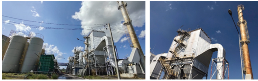
ภาพการบำบัดมลพิษทางอากาศด้วยเทคโนโลยีดักจับฝุ่นแบบไฟฟ้าสถิตย์(ESP)
